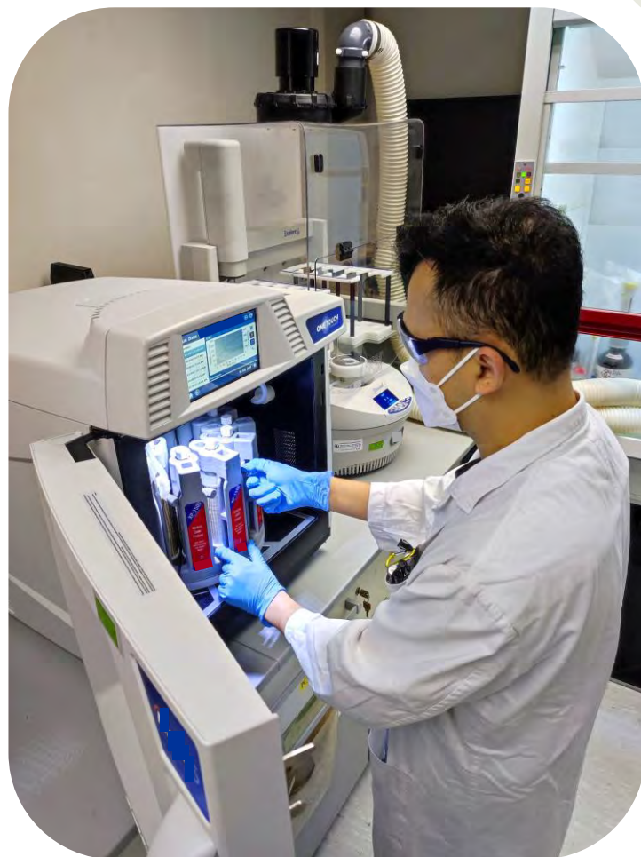
以微波消解系统检测药剂制品内的元素杂质
