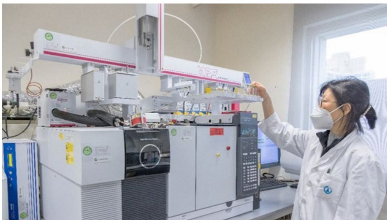
用於測定中藥材二氧化硫殘留量的氣相色譜儀(配備熱導檢測器)。
