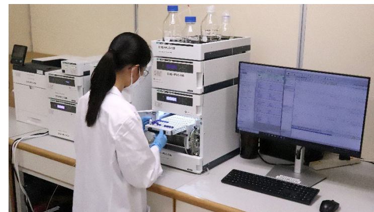
用於分析手性物質的高效液相色譜儀(配備光電二極體陣列檢測器及圓偏振光二色檢測器)。
