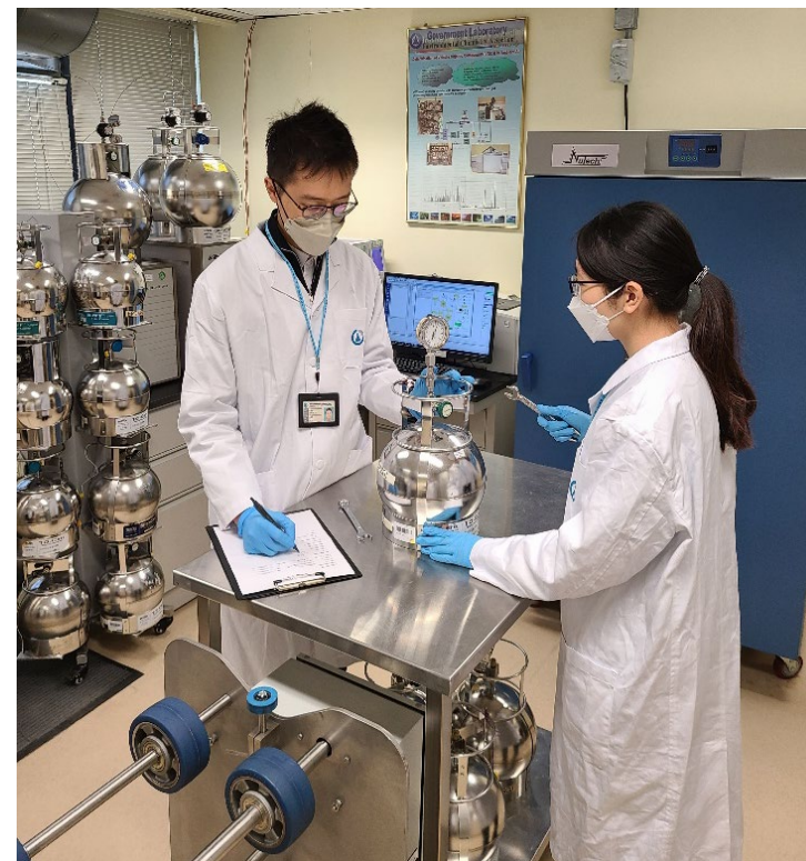
在分析大氣中的揮發性有機化合物前檢查採樣罐的氣壓。
