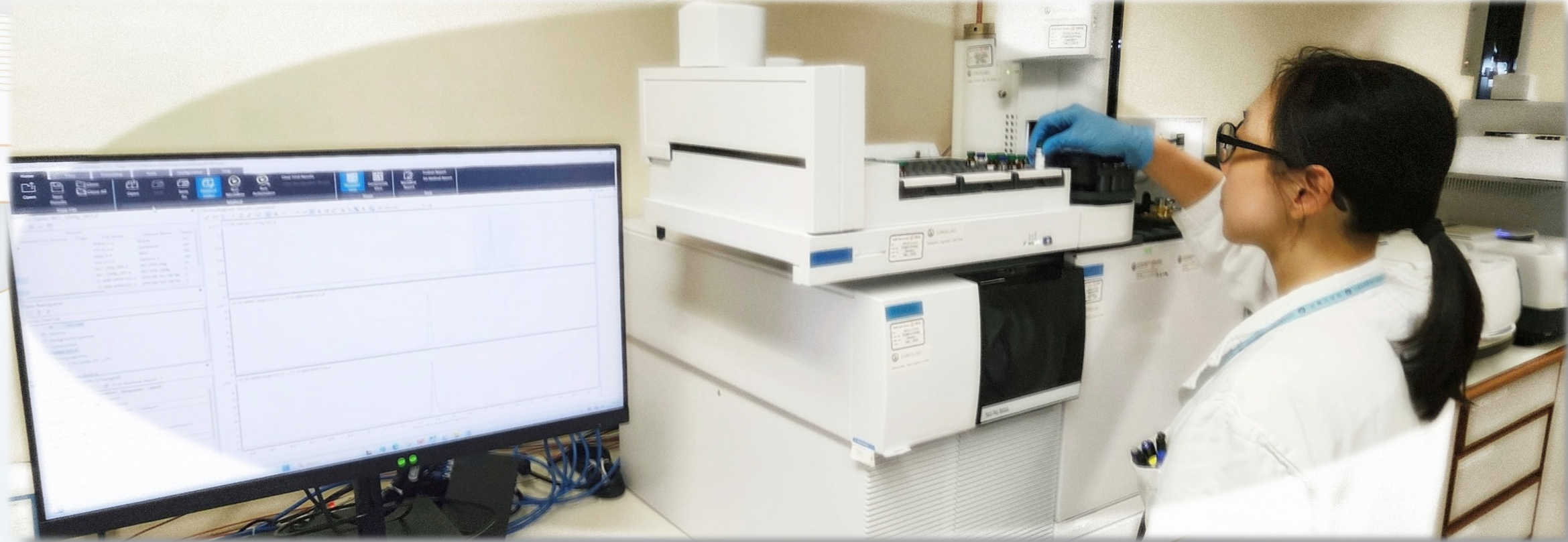
以气相色谱串联质谱联用仪系统分析环境样本中有机氯类除害剂 (OCPs)。
