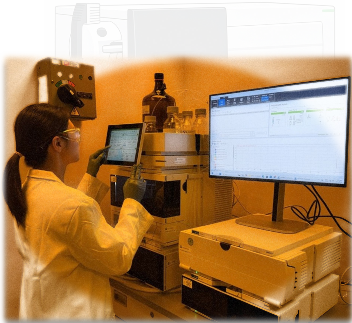
在维他命化验室利用高效液相色谱仪系统对维他命样本进行有效成份的分析测试。
